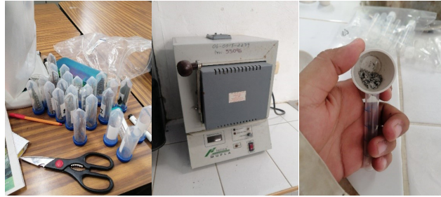
Figura 7, 8 y 9. Parte del protocolo de laboratorio para la recuperación de fitolitos: [primera fotografía] obtención de muestras, [segunda fotografía] quema de las muestras, y [tercera fotografía] traspaso de las cenizas a tubos de ensayo.
